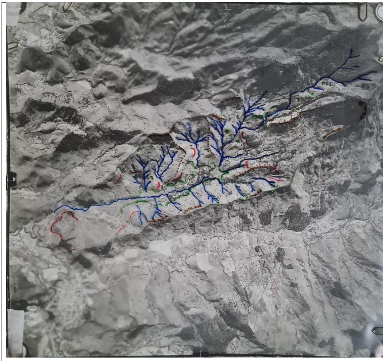
Figura 2. Exemplo do overlay de aerofotointerpretação da morfologia (em andamento) na Bacia Hidrográfica do Quilombo.
